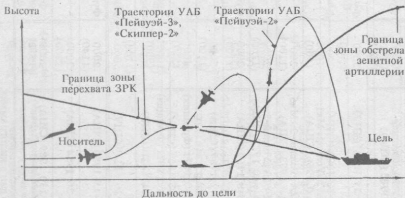
Рис. 4. Схема боевого применения УАБ серии «Пейвуэй»
