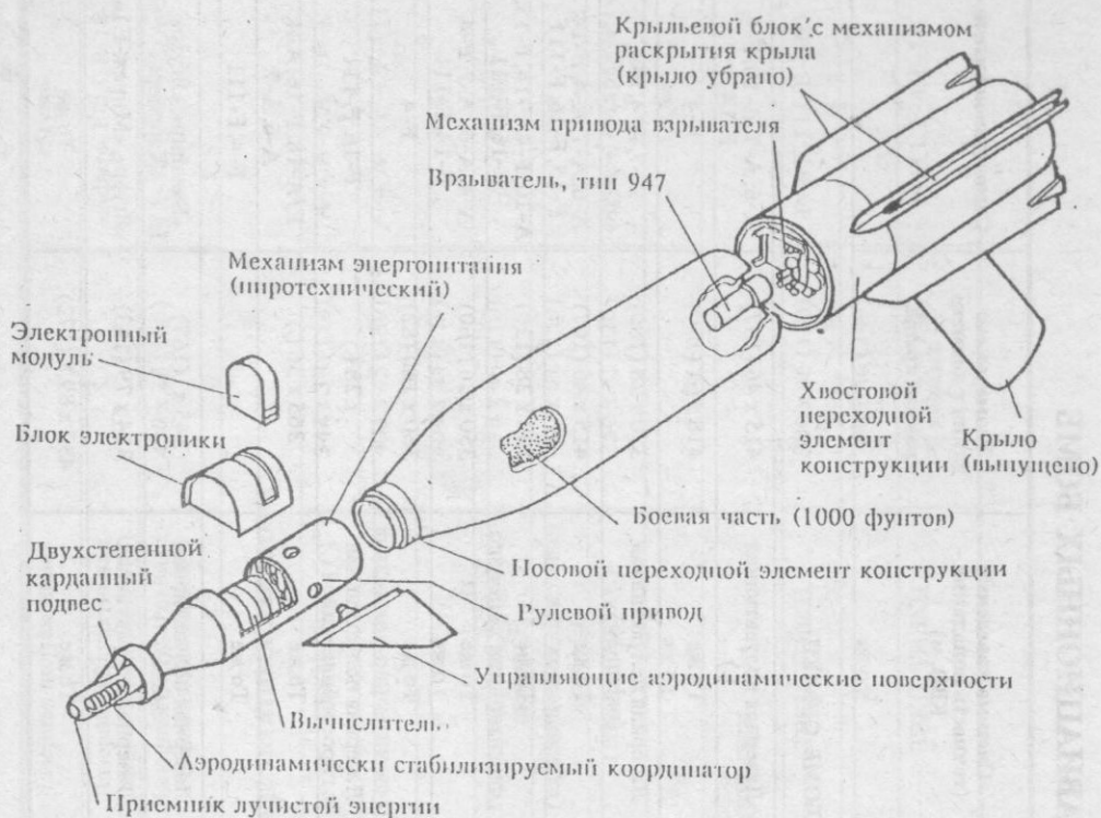
Рис. 3. Компонентная схема бомбы Mk 13/18
